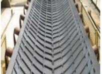
Ленты с гладкой несущей поверхностью пригодны для транспортировки упакованных и неупакованных грузов, если угол наклона не превышает 22° (верхняя граница). Если необходим больший угол транспортировки, требуется использование шевронной ленты (Chevron) с резиновыми выступающими профилями (рёбрами).
